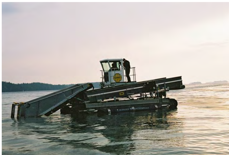
Faucardeur Lamor RS-500 en conditions amphibies (photo constructeur)
