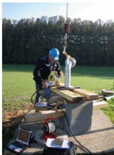
Diagraphie dans un forage. Elle consiste à mesurer à l'aide de différentes sondes les caractéristiques des roches traversées lors du forage (porosité, fracturation etc.) mais aussi la température de l'eau, conductivité électrique, salinité.
