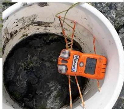
Conditions relativement peu propices à des mesures de fortes concentration / vent soutenu (20 rafales à 40), température 17-18 °C. Nombreuses mesures (y compris films) dans les zones de filières en putréfaction. Systématiquement en brassant on obtient des valeurs de plusieurs centaines de ppm.
