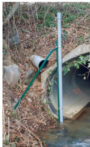
Limnimètre installé sur la Flume
