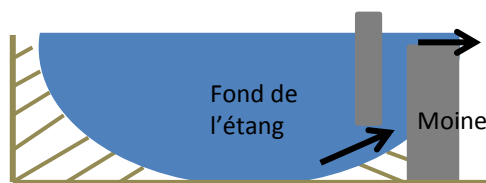
Figure 5 : Système de déversoir de fond par moine (source personnelle)
