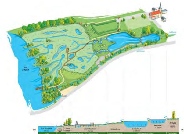
Schéma du système de pré-barrage du lac d'Aydat
