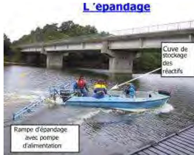
Embarcation permettant d'épandre en surface du plan d'eau la solution de cuivre
