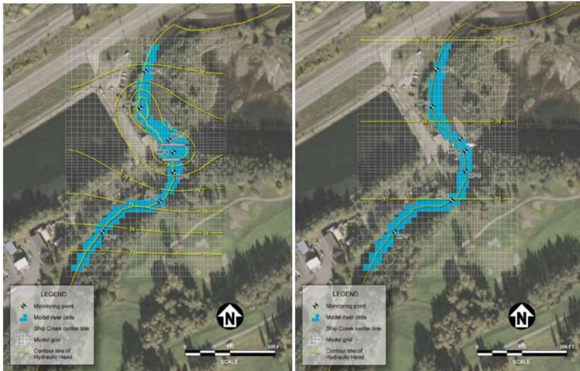
Figure 16 : Exemple de modélisation des effets d'une suppression de seuil sur le niveau de la nappe d'accompagnement (Show environmental, 2006, dans l'étude de Malavoi, 2011)
