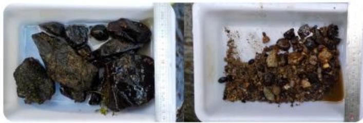
Granulométrie de la couche d'armure (gauche) et de la sous-couche (droite) sur le Voaz Ven (22)
