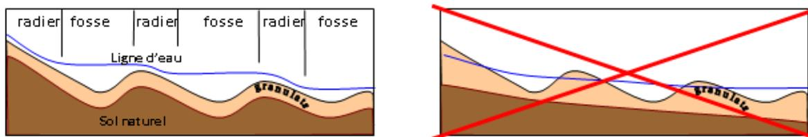
Figure 10 : Réalisation du profil en long d'un cours d'eau intermittent
