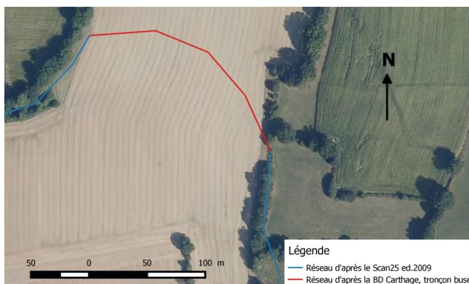
Figure 6 : Exemple de pré-identification de tronçons enterrés par comparaison d'orthophotographies avec le réseau complété à partir de la BD Topo, de la BD Carthage et du Scan 25 de l'IGN. Fond de carte : IGN, 2014.
