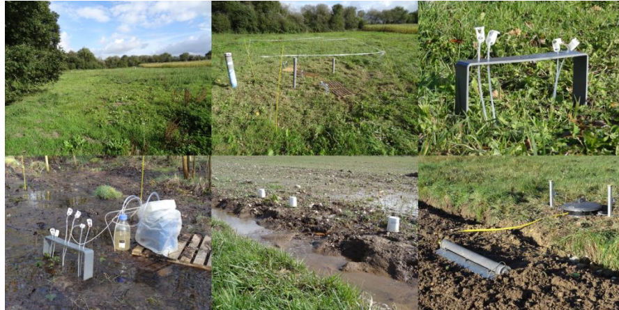
Figure 7. Photographies des différents dispositifs de collecte de l'eau de ruissellement et de l'eau du sol implantés sur les transects de Guériniec et Kerroland
